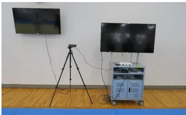
①柔道場に設置された、ビデオカメラ・画像遅延装置・大型モニター・移動式収納ラックのセットです。
